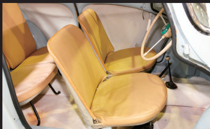
前排座椅的設計非常簡單。後排座椅的靠背可以向前摺疊，這樣可以方便進入後部引擎的維修孔。
