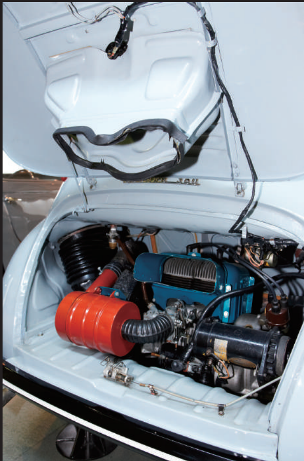
搭載於後部的2行程2缸引擎。由於是強制氣冷式設計，引擎罩內設有排放冷卻風的風道。對引擎的進氣來自前部空氣清淨器透過風道進入。
