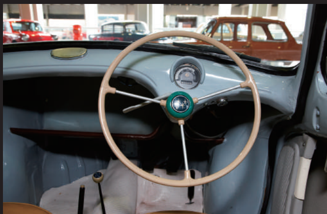
中控台也十分簡潔，儀錶僅有速度錶和里程錶。操作系統只有方向盤和左手控制的方向燈桿。
