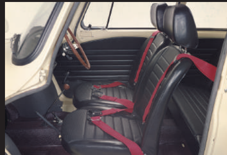
於昭和43年推出的「年輕SS」。前排座椅裝有頭枕和3點式安全帶。
